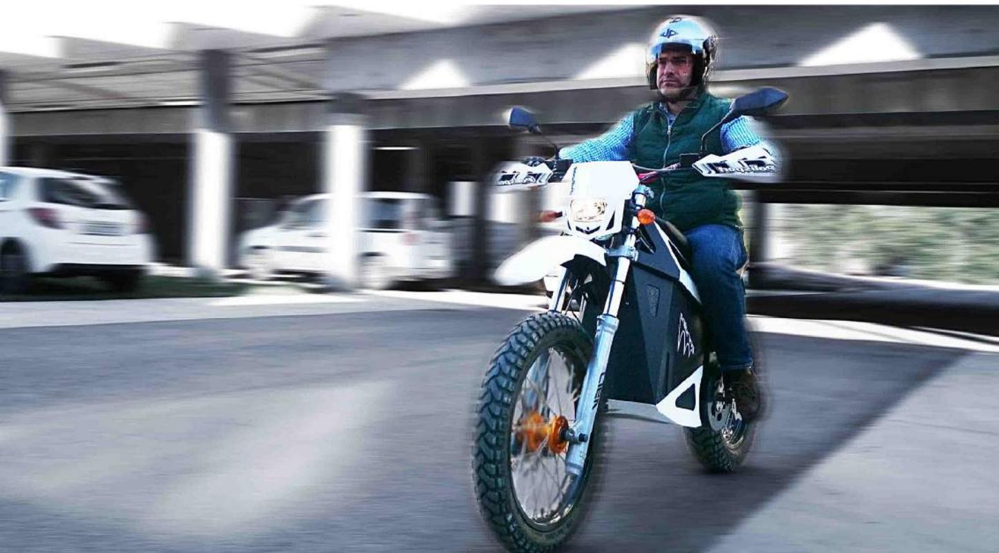
Su batería de Litio LIFePO de 4kWh le permite afrontar los retos diarios con solvencia, pues en función del ritmo de conducción, podremos llegar a más de 200 kms en ciudad y más de 120kms en conducción off road. Dispone de dos modos de conducción FULL y ECO que nos permitirá aumentar las prestaciones o la autonomía.
